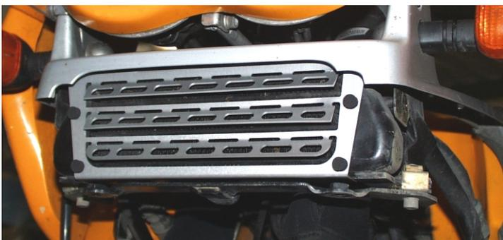
Der Ölkühlerschutz wird nun einfach auf den Ölkühler aufgeschoben. Ein Verdrehen des Ölkühlerschutzes ist **ohne** Gewaltanwendung nicht möglich.
