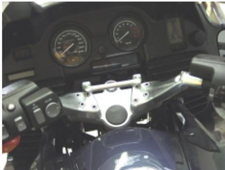
Der Anbauadapter wird mit den beiden bei-liegenden Schrauben Innensechskant M8x16 mit je einer U-Scheibe M8 von vorne (in Fahrt-richtung gesehen) gegen die obere Gabel-brücke montiert. Die beiden Schrauben werden dabei in die vorhandenen Gewinde auf der Unterseite der Gabelbrücke geschraubt.
