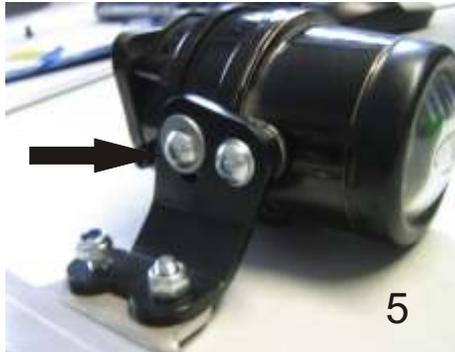
5.) Montieren Sie nun den Xenon Scheinwerfer an die Aufnahmeplatte. Dazu verwenden Sie die M6x14 Linsenkopfschrauben, eine U-Scheibe M6 groß am Langloch und eine U-Scheibe M6 klein am normalen Loch. (Bild 5)
