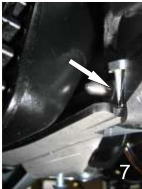
7.) Entfernen Sie die linke Schraube vom Kotflügel, und ziehen die Klemmmutter, auf der Gegenseite, von der Halterung ab. (Bild7)
