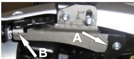
8.) Verwenden Sie nun die Linsenflanschkopfschraube M5x30 und "schrauben" Sie diese an der linken Seite an die Kotflügelaufnahme, damit Sie einen Fixierungspunkt für die Scheinwerferaufnahme haben. Setzen Sie nun die Aufnahmeplatte wie in Bild 8 gezeigt auf die Lasche am Rahmen (A). Fixieren Sie die Platte im vorderen Bereich (B) an der Kotflügelschraube (Bild 8b).
