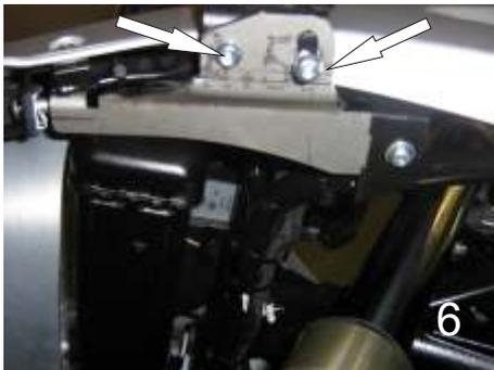
6.) Nun Montieren Sie die Aufnahmeplatte an der Halteplatte mit den Linsenkopfschrauben M6x16, einer U-Scheibe M6 groß am Langloch und einer U-Scheibe M6 klein am normalen Loch. (Bild6)
