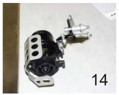
15.) Der Scheinwerfer kann jetzt an der linken Verkleidungsseite, an den vorher freigelassen Verschraubungspunkten, montiert werden. Im vorderen Bereich verwenden Sie dazu bitte eine Schraube M6x55, eine U-Scheibe und die lange Distanz und im hinteren Bereich eine Schraube M6x40, eine U-Scheibe und die (Photos 13, 14, 15) kurze Distanz.
