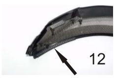
12.) In dem Bereich, wo das Kabel unter der Verkleidung heraus kommt, bringen Sie bitte den im Lieferumfang enthaltenen Kantenschutz an. Schieben Sie diesen dazu über die Kante der Verkleidung. (Bild 12)
