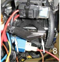
9.) Ziehen Sie das rote Kabel zum linken Anschluss der Hauptsicherung; die braunen werden zum Masseanschluss am Motor auf der rechten Seite verlegt. Kürzen Sie die Kabel entsprechend uns befestigen Sie diese mit Hilfe der mitgelieferten Kabelverbinderringösen an den jeweiligen Anschlüssen. (Bild 9)
