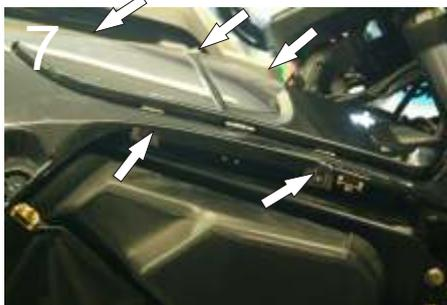
Zur Demontage des rechten Verkleidungsteils muss der Deckel des Radiofachs zusätzlich abgeschraubt werden. Dieser ist mit zwei Schrauben (Abb. 7) befestigt.
