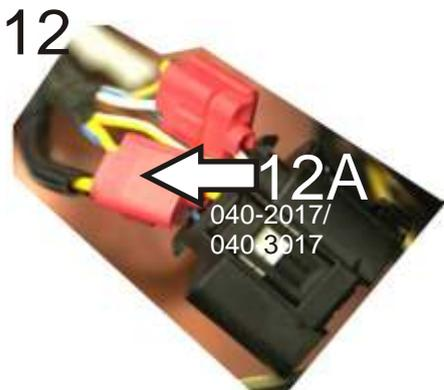
Das gelbe Kabel zum Anschlussstecker des Hauptscheinwerfers ziehen; kürzen Sie das Kabel auf die passende Länge und schließen Sie es mit dem mitgelieferten Kabelabzweiger an dem gelben Kabel anschließen (Abb. 12).
