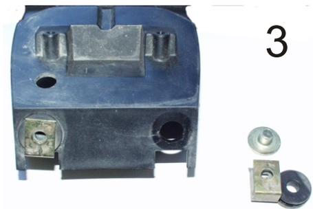
3.) Jetzt werden die Gummitülle, die Buchse und der Mutterhalter aus dem originalen Kennzeichenträger entfernt. (Bild 3) Diese werden wieder in dem neuen TT- Kennzeichenträger eingebaut. (Bild 4)
