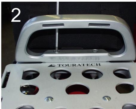
2.) Durch lösen der zwei Haltegriffschrauben (Bild 2) kann jetzt der Kennzeichenträger abgenommen werden. Halten Sie dabei den Kennzeichenträger mit einer Hand fest, sonst kann dieser, zusammen mit dem Kotflügel nach unten fallen.
