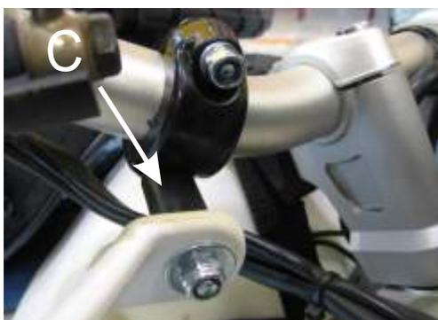
Bringen Sie nun die Klemmen am Lenker an. Dazu brauchen Sie die Schrauben M6x35 und M6x70 mit Muttern und U-Scheiben. Mit der längeren Schraube wird gleichzeitig der Protektor an der Klemme befestigt, wobei hier die Kunststoffdistanz zwischen Klemme und Protektor kommt, C.
