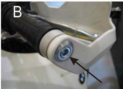
Befestigen Sie jetzt die Protektoren an den Lenkerenden. Dazu brauchen Sie den Unterlegteiler M8 und die Schraube M8x30, ebenso die Aludistanz, B. Schrauben noch nicht anziehen.
