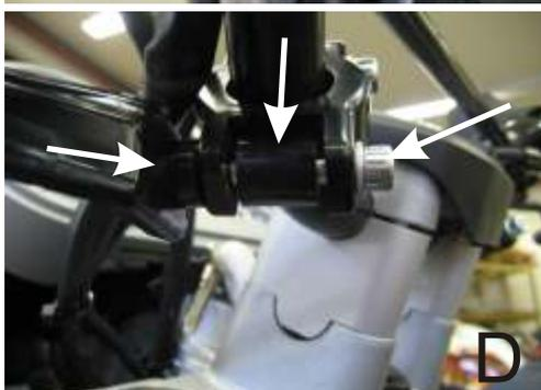
Bringen Sie jetzt Die Lenkerklemme am Lenker an, C. Dazu brauchen Sie die Schraube M6x40 mit zwei U-Scheiben und der Mutter M6. Die Schraube ist für die obere Klemmung. Schraube noch nicht anziehen.
