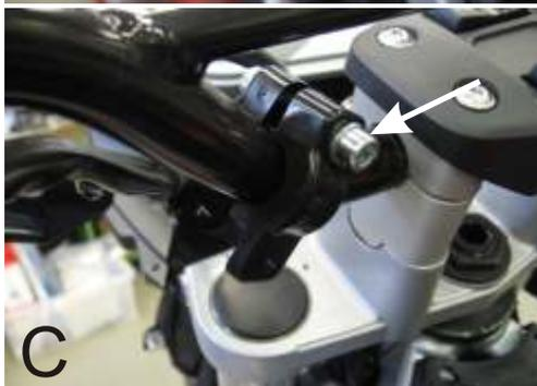
Schrauben Sie nun den Protektor am Lenkerende fest. Hierfür benötigen Sie die Schraube M6x20, den Unterlegteller M6 und die Aludistanz. Siehe Bild B.
