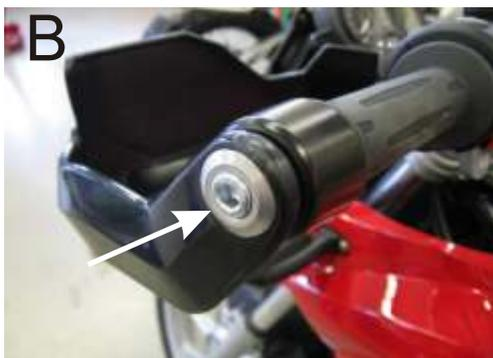
Tauschen Sie die Senkkopfschraube gegen die beigelegte Senkkopfschraube aus, diese hat ein Innengewinde M8. Drehen Sie die Schraube in das Lenkerende und ziehen Sie sie fest an. Befestigen Sie anschließend den Protector. Hierzu benötigen Sie den Unterlegsteller M8 und die Zylinderkopfschraube M8x30, B.
