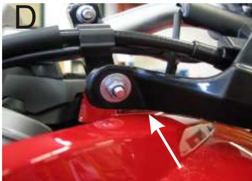
Vor dem festziehen der Schrauben, den Protector richtig positionieren. Dabei darauf achten, dass der Protector, wenn der Lenker voll eingeschlagen ist, nicht am Verkleidungscover anschlägt.
