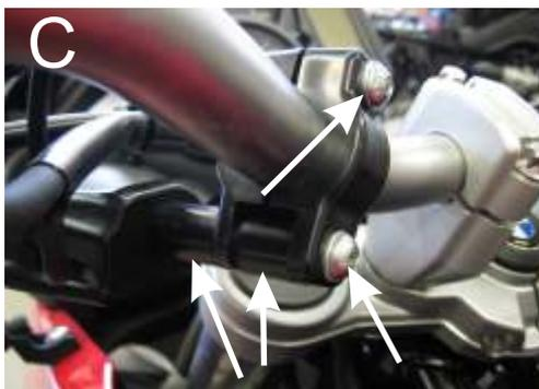
Legen Sie nun die Lenkerklemme am Lenker an. Dazu benötigen Sie die Linsenkopfschrauben M6x40 und M6x70. Wobei Sie die längere Schraube für die untere Klemmung benutzen, mit ihr wird auch gleichzeitig der Protector befestigt. Die kürzere der beiden Distanzen wird zwischen die Klemmen geklemmt, die längere dient als Abstand zum Protector. Vergessen Sie die Unterlegscheiben nicht, C. Die Schrauben werden mit den Muttern M6 festgezogen.
