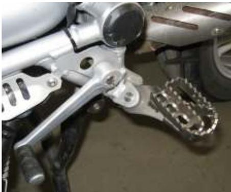
2.) Setzen Sie bitte die neuen Fußraste analog zu den Originalen in die Fußrastenaufnahme mit Hülse, Feder und Bolzen ein. Die Sicherung erfolgt dann wiederum mit U-Scheibe und neuem Splint (bei Modellen ab R1200GS mit der vorhandenen Sicherungsscheibe).
