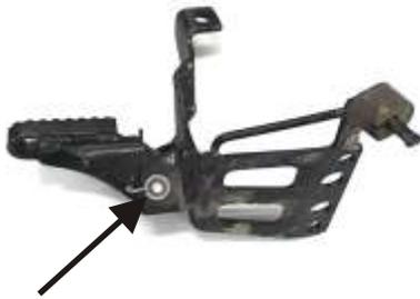
1.) Entfernen Sie bitte bei den Modellen vor R1200GS den Splint (auf die U-Scheibe achten) aus Ihrer Fußrastenaufnahme (bei den Modellen ab R1200GS entfernen Sie bitte die Sicherungsscheibe) und ziehen dann den Bolzen heraus. Bolzen, Hülse, Feder und U-Scheibe werden wiederverwendet (bei Modellen mit Sicherungsscheibe, auch diese).
