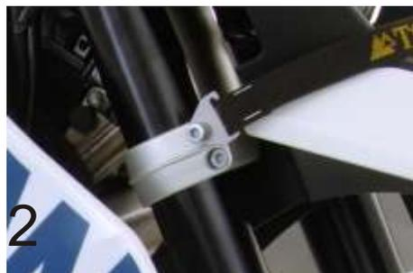
1.) Entfernen Sie die oberen Schrauben
