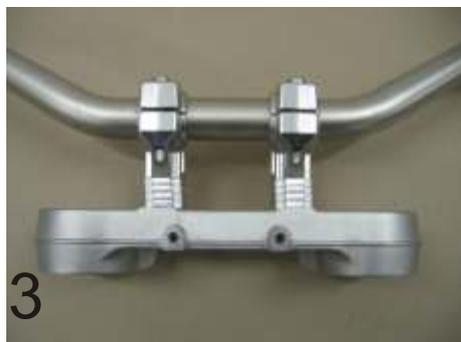
**HINWEIS:** Bei Erhöhung von 5-10mm müssen die mitgelieferten M10x80 Zylinderschrauben verwendet werden Bild1! Bei Erhöhung von 15-20mm müssen die mitgelieferten M10x90 Zylinderschrauben verwendet werden Bild1!
