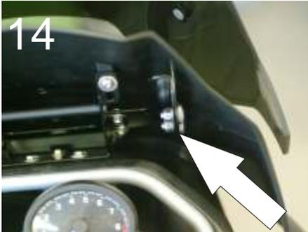
Setzen Sie das Windschild auf die Verkleidung, so dass die Verstellwinkel durch die Führungen in der Verkleidung greifen (Abb. 14). Verschrauben Sie die Verstellwinkel mit den Schlossschrauben M6x16, Distanzscheibe von außen und U-Scheibe M6 und Mutter selbstsichernd M6 von innen (Abb. 14 + 15).
