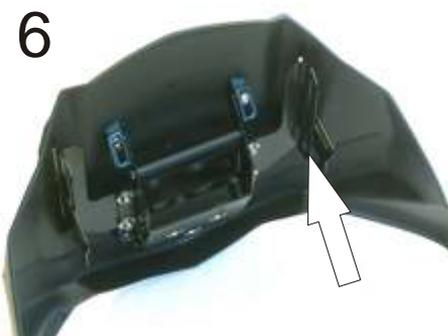
Zur Ausrichtung der vormontierten Einheit schrauben Sie diese bitte mit einer Schraube Linsenkopf M5x10 ("1") in die Verkleidung. Richten Sie die Aufnahme so aus, dass die Verstellung links / rechts ("E" / "D") parallel laufen, an der Aufnahme gut anliegen und sauber durch die Führung in der Verkleidung passen (Abb. 6)
