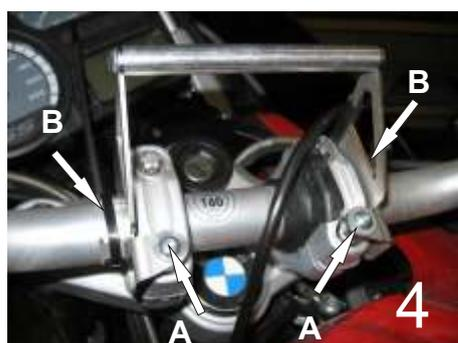
4.) Setzen Sie den Anbauadapter auf die ersetzten Schrauben und befestigen Sie diese mit den im Lieferumfang enthaltenen Schrauben M5x12 sowie mit den U-Scheiben M5. (Bild 4 - A)
