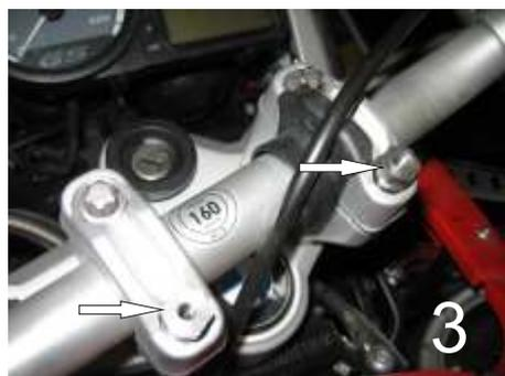
3.) Entfernen Sie die zwei im Bild bezeichneten original Schrauben der Lenkerklemmung und ersetzen Sie diese durch die Sechskantschrauben. **Hinweis:** Wenn Sie die Schrauben nacheinander austauschen, bleibt die Lenkerposition eingestellt.
