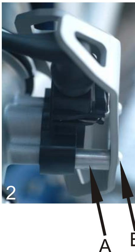
Schrauben Sie die originalen Schrauben des Drosselklappenpotis heraus.
