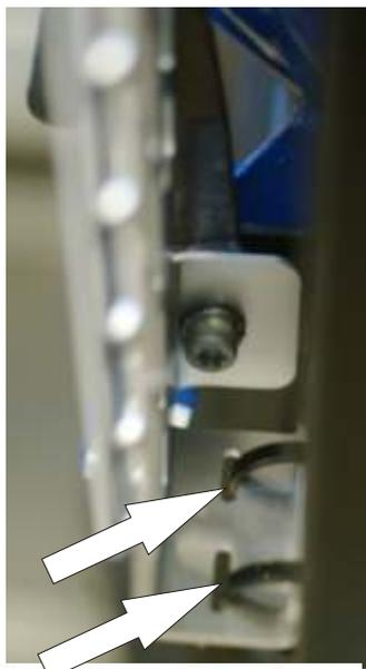
Demontieren Sie bitte das linke Seitenteil Ihrer BMW HP2 (5 Schrauben Torx) und lösen die Befestigungsschraube "A" des Ölkühlers.
