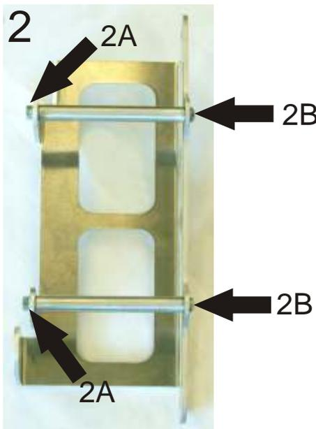
Setzen Sie das Hard Part von hinten auf den Ölkühler auf. Die hintere Befestigungslasche liegt dann vor dem Ölkühler, die vordere Befestigungslasche liegt dann zwischen Ölkühler und Rahmen.
