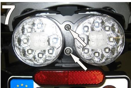
10. Die vormontierte Blende mittels der beiden Schrauben an der Grundplatte anschrauben und darauf achten, dass das Kabel der Kennzeichenbeleuchtung nicht verklemt wird!
