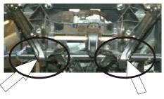
Lösen Sie die Sicherungsclips der Mechanik des Windschilds und ziehen die Bolzen ab. so dass Sie im folgenden die Verstellhebel durch die Verkleidung führen können.
