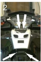
Fahren Sie das Windschild in die oberste (steilste) Position und demontieren es.
