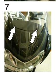
Demontage Verkleidung: Schrauben Sie die markierte Schraube "8" (links wie rechts) heraus.
