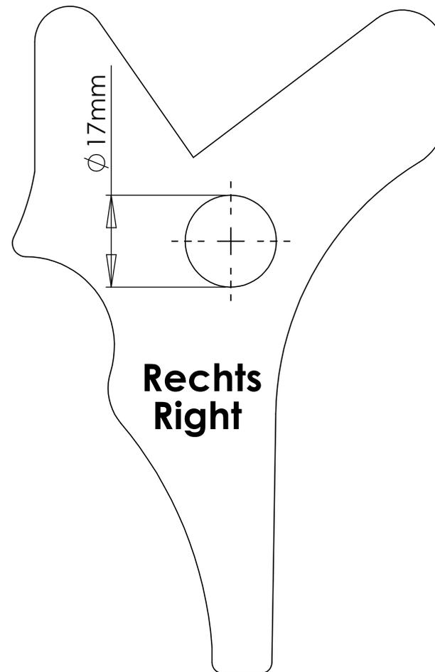
Bitte das Maß 80/40mm prüfen, bevor Sie bohren. TOURATECH AG übernimmt keine Haftung für falsch gebohrte Löcher!
