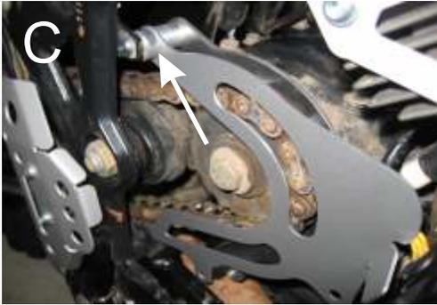
Fädeln Sie die Distanz 7mm, die Blende und eine Distanz 16mm und dann das Innenblech auf die Schraube M5x40 und schrauben Sie anschließend die M5er Mutter mit U-Scheibe zur Befestigung auf. Die Mutter noch nicht fest ziehen!
