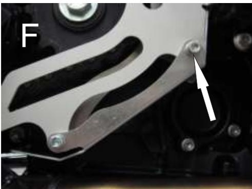
Jetzt legen Sie sich das Kettenfett-Schutzblech neben Ihre Montagestelle. Mit einer Hand drücken Sie Ihren montierten Ritzelschutz gegen den Motorblock, mit der anderen drehen Sie die im Bild F markierte Schraube wieder heraus. Achten Sie auf genügend Druck, sodass die Distanzen nicht herausfallen. Jetzt nehmen Sie den Schutz und bringen ihn i.V.m. der entfernten Schraube an. Zur Befestigung mit der zweiten Schraube gehen Sie gleich vor.
