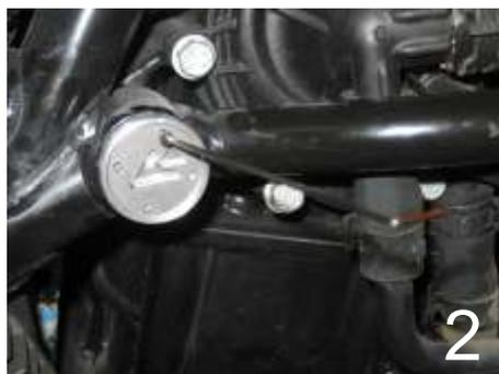
4.) Setzen Sie den Rahmenstopfen in den Rahmen Ihres Motorrades ein und drehen Sie ihn in die richtige Position. Drücken Sie nun den Rahmenstopfen vorsichtig, aber doch mit ausreichendem Druck hinein, so dass der O-Ring verschwindet. (Bild1) (Pfeil zeigt die Druckrichtung)
