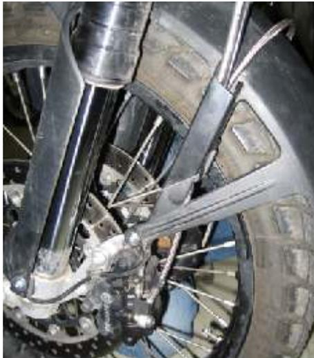
**Anleitung: Kotflügelhöherlegung mit Stahlflex-Bremsleitung BMW F800GS**
