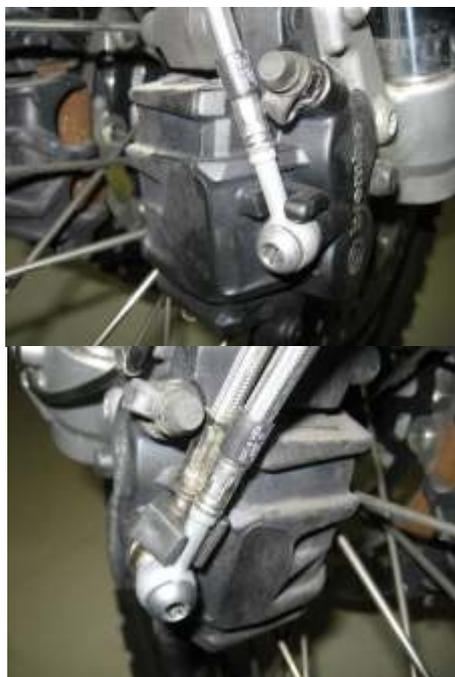
10. Stahlflex-Bremsleitung über Kotflügel legen und mit 2 x Alu-Dichtung rechts und 3 x links befestigen (Bild 9 u. 2) Achtung! Anziehmoment beachten! Leitung nicht verdreht montieren!
