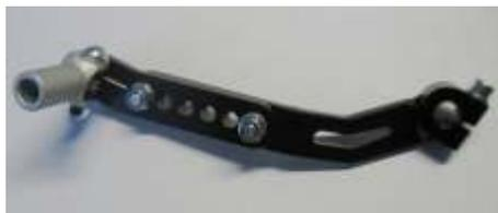
2.) Bauen Sie den neuen Schalthebel wie im Bild 2 gezeigt zusammen und achten Sie dabei darauf, dass der in den wichtigen Hinweisen beschriebene "Sicherheitsabstand" eingehalten wird. Die Liko-Schrauben werden jeweils mit einer U-Scheibe **von hinten** nach vorn durch den Hebel und das Verschiebeteil gesteckt und von vorn jeweils mit einer U-Scheibe und einer Mutter M6 festgeschraubt (max. Drehmoment 7,3Nm)
