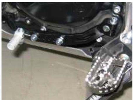
3.) Bauen Sie den längenverstellbaren Schalthebel an Ihr Motorrad und sichern Sie ihn mit der Zyko-Schraube M6x25, kombiniert mit der U-Scheibe.
