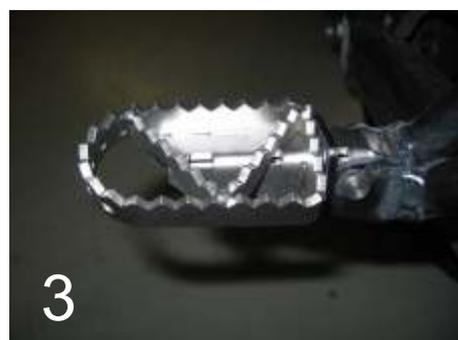
2.) Setzen sie den O-Ring (B) auf die Krallenfußrasten und setzen Sie das Klappblech (C) davor.
