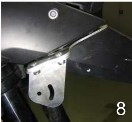
**WICHTIG:** Der Zusatzscheinwerfer sollte so an der Halteplatte montiert werden, dass die Biegeseite nach innen, zum Kotflügel hin, zeigt. (Siehe Bild 8)
