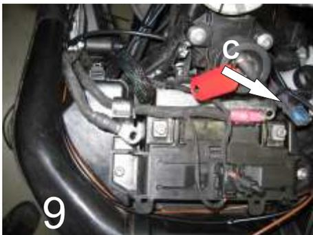
7.) Die vom Relais ausgehenden Kabel verlegen Sie bitte zur Batterie hin. (braunes Kabel zu Batterie-Minus, rotes Kabel zu Batterie-Plus) Verlegen Sie die Kabel so, dass sie beim Zusammenbau der Verkleidungsteile nicht gequetscht werden. Bringen Sie die Sicherung (C) an dem roten Kabel in der Nähe des Batteriefachs an. Schließen Sie die Kabel noch nicht an. (Bild 9)
