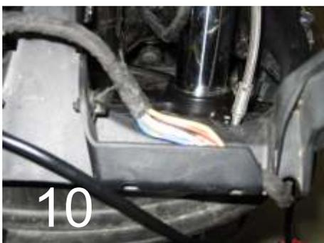
Stellen Sie nun die Verbindung mit dem Abblendlicht her. Dazu schneiden Sie bitte vorsichtig die schwarze Kabeltülle des original Kabelbaums auf, der im vorderen Bereich der Scheinwerfereinheit liegt (Bild 10).
