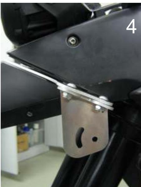
**WICHTIG:** Der Zusatzscheinwerfer sollte so an der Halteplatte montiert werden, dass die Biegeseite nach innen, zum Kotflügel hin, zeigt. (Siehe Bild 3)
