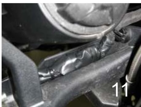
11.) Isolieren Sie die freigelegte Stelle mit Isolierband und legen Sie den Kabelbaum wieder in die dafür vorgesehene Mulde. Befestigen Sie alles mit Kabelbindern. (Bild 11)
