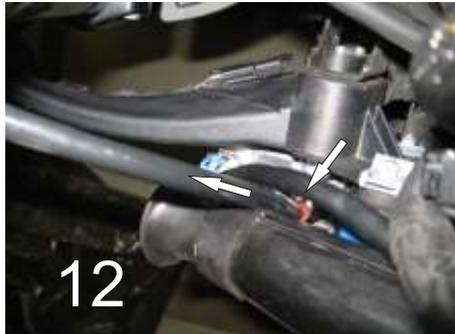
12.) Verlegen Sie nun das vom Steuergerät ausgehende Kabel, wie in Bild 12 gezeigt, hinter dem Lufteinlass nach oben, so dass Sie es, nachdem Sie die Seitenverkleidung wieder angebracht haben, über diese legen können. Schließen sie den Scheinwerfer nun an. Setzen Sie den Stecker auf 11 Uhr in den Scheinwerfer und drehen Sie ihn im Uhrzeigersinn auf 12 Uhr. Achten Sie darauf, das der Stecker richtig einrastet.
