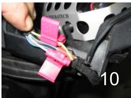
10.) Schließen Sie mit Hilfe des roten Kabelverbinders das weiße Kabel des Fernlichts, mit dem gelb-grauen Kabel des Zusatzscheinwerfers zusammen. (Bild 10) (in diesem Bild sind Zusatzscheinwerfer Nebel und Xenon angeschlossen) Kürzen Sie das gelb-graue Kabel des Zusatzscheinwerfers auf die nötige Länge ab.
