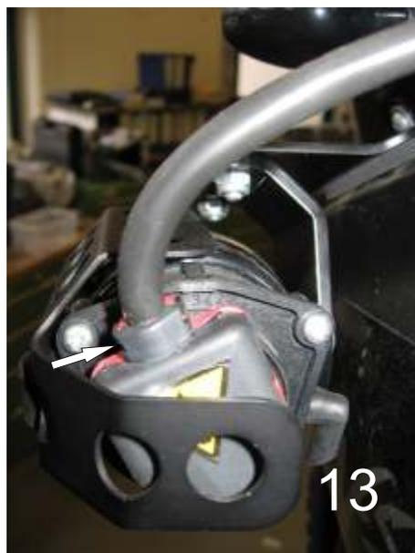
**VORSICHT! HOCHSPANNUNG! LEBENSGEFAHR!** Schalten Sie die Stromversorgung erst ein, wenn der Stecker im Scheinwerfer eingearastet ist!
