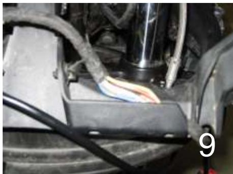
9.) Stellen Sie nun die Verbindung mit dem Fernlicht her. Dazu schneiden Sie bitte vorsichtig die schwarze Kabeltülle des original Kabelbaums auf, der im vorderen Bereich der Scheinwerfereinheit, unterhalb des Scheinwerfers, liegt (Bild 9).
