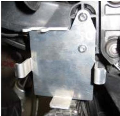
6.) Nun können Sie das Steuergerät für den Xenon-Fernscheinwerfer einsetzen. Sichern Sie dieses mit dem O-Ring, welcher im Lieferumfang enthalten ist.
