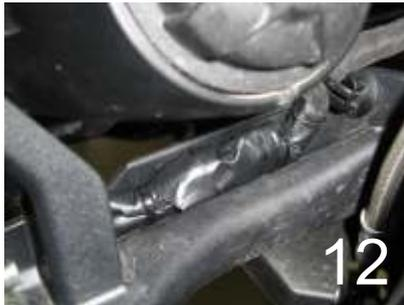
9.) Isolieren Sie die freigelegte Stelle mit Isolierband und legen Sie den Kabelbaum wieder in die dafür vorgesehene Mulde. Befestigen Sie alles mit Kabelbindern. (Bild 12)
