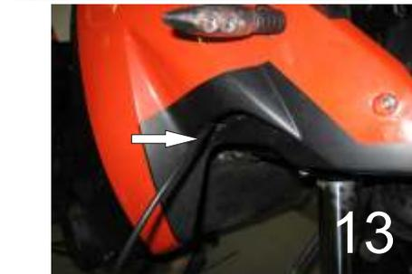
10.) Ziehen Sie die zweiadrigen rot/blau Kabel auf die rechte und linke Seite zu den Zusatzscheinwerfer. Führen Sie die Kabel dabei, wie in Bild 13 gezeigt durch die Lufteinlässe der Seitenverkleidungen. Ziehen Sie jeweils das Kabel durch die dafür vorgesehenen Durchgänge an der Unterseite der hinteren Nebelscheinwerferabdeckung (Bild 14). Bringen Sie danach die im Lieferumfang enthaltenen Kabelverbinderstecker an den Kabeln an.
