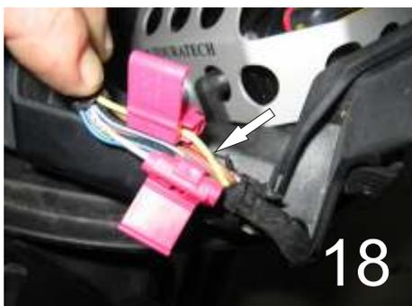
Das gelbe Kabel des Ablendlichts wird mit dem gelben Kabel des Zusatzscheinwerfers verbunden. Das weiße Kabel des Fernlichts wird mit dem gelb-grauen Kabel des Zusatzscheinwerfers verbunden. (Bild 18) (in diesem Bild sind Zusatzscheinwerfer Nebel und Xenon angeschlossen) Kürzen Sie das gelbe und das gelb graue Kabel der Zusatzscheinwerfers auf die nötige Länge ab.
