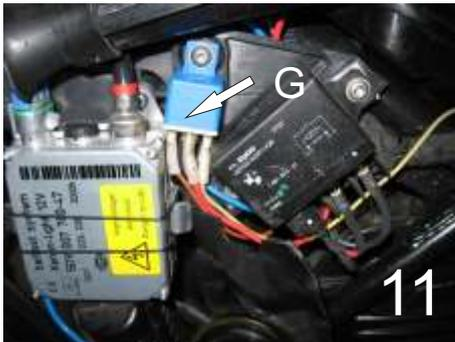
10.) Positionieren Sie das Relais (G) des Kabelsatzes für den Xenonscheinwerfer in der Nähe des Steuergerätes und befestigen Sie es, so dass es nicht lose herum fallen kann. (Bild 11)
