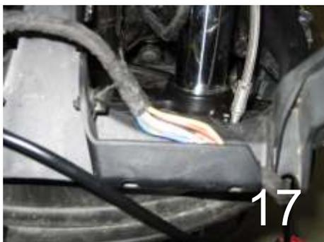
12.) Schließen Sie nun mit Hilfe der roten Kabelverbinder die Zusatzscheinwerfer an die Elektronik Ihres Motorrads. Dazu schneiden Sie bitte vorsichtig die schwarze Kabeltülle des original Kabelbaums auf, der im vorderen Bereich der Scheinwerfereinheit, unterhalb des Scheinwerfers, liegt (Bild 17).
