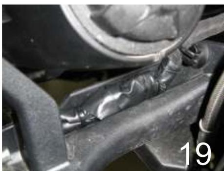
13.) Isolieren Sie die freigelegte Stelle mit Isolierband und legen Sie den Kabelbaum wieder in die dafür vorgesehene Mulde. Befestigen Sie alles mit Kabelbindern. (Bild 19)
