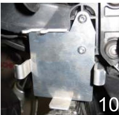
9.) Nun können sie das Steuergerät für den Xenon-Fernscheinwerfer einsetzen. Sichern Sie dieses mit dem O-Ring, welcher im Lieferumfang enthalten ist.
