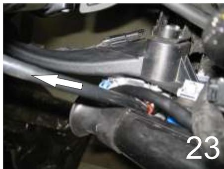
8.) Verlegen Sie nun das vom Steuergerät ausgehende Kabel, wie in Bild 23 gezeigt, hinter dem Lufteinlass nach oben, so dass Sie es, nachdem Sie die Seitenverkleidung wieder angebracht haben, über diese legen können. Schließen sie den Scheinwerfer nun an. Setzen Sie den Stecker auf 11 Uhr in den Scheinwerfer und drehen Sie ihn im Uhrzeigersinn auf 12 Uhr. Achten Sie darauf, das der Stecker richtig einrastet. (Bild 24)
