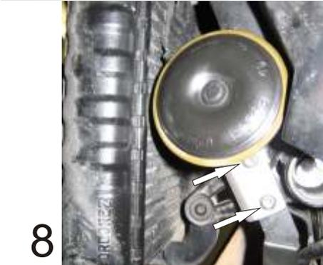
Demontieren Sie die Schraube an der linken unteren Kühleraufnahme und entfernen Sie diese. (Bild 8) Setzen Sie das Hupenverlegungsblech an die Stelle, wo Sie die Schraube entfernt haben und befestigen Sie es, wie in Bild 8 gezeigt, mit den im Lieferumfang enthaltenen LiFlaKo Schrauben M6x20 V2A.
