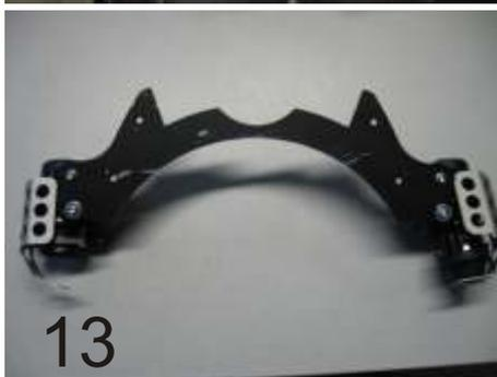
5.) Montieren Sie als Nächstes die Halterung für den Zusatzscheinwerfer. Verwenden Sie dazu die Aufnahmeplatte (B) und setzen Sie diese auf den Kotflügel auf. Schrauben Sie den Kotflügel samt Aufnahmeplatte wieder an ihren Platz; verwenden Sie dazu die im Lieferumfang enthaltenen Schrauben LiFlaKo Torx M5x30 anstelle der original Schrauben. (Bild.13)
