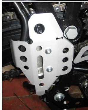
Befestigen Sie den Bremszylinder mit der Abdeckung und den original Schrauben. (Bild 9)
