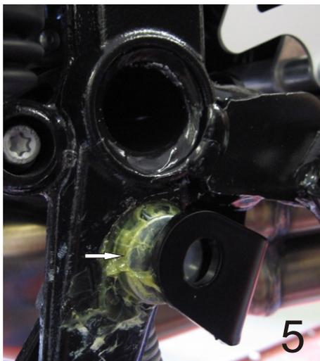
6.) Setzen Sie nun die rechte Seite des Sturzbügels an. Dabei müssen Sie ihn zuerst zwischen Fußrastenaufnahme und Krümmer einfädeln, so dass der untere Aufnahmepunkt (Bild 5) erreicht wird. Stecken Sie dann die befestigte Aluminiumbuchse an der Stelle in den Rahmen, wo Sie den Rahmenstopfen entfernt haben. Ziehen Sie die Schraube leicht an, so dass der Sturzbügel nicht mehr herab fallen kann. (Bild 4)
