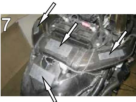
7. Kleben Sie Zellgummi-Zuschnitte der beigelegten 10mm Matte wie in Bild 7 auf die zuvor entfetteten und gereinigten Stellen an der Airbox und den Ansaugstutzen!
