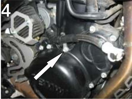
4. Verlegen Sie den Benzinschlauch auf der rechten Seite wie auf den Bildern 4 und 5 dargestellt! Den Schlauch dabei hinter dem Gleichrichter durchführen! Befestigen Sie 1 x Halblech Benzinleitung mit einer Originalschraube am Lichtmaschinendeckel wie in Bild 4 dargestellt und sichern Sie den Schlauch mit einem der beigelegten 290mm Kabelbinder! Der Schlauch kann auch an der Innenseite des Halblechs befestigt werden!
