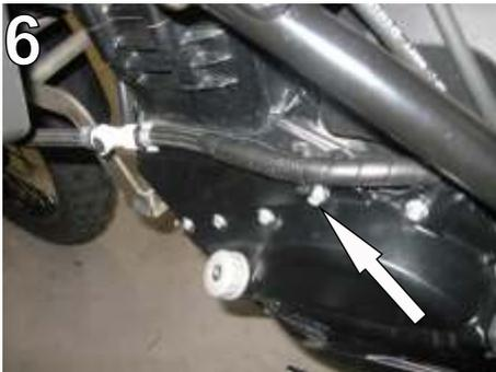
5. Verlegen Sie den Benzinschlauch auf der linken Seite wie auf Bild 6 dargestellt! Befestigen Sie hier ebenfalls 1 x Halblech Benzinleitung mit einer Originalschraube am Kupplungsdeckel und sichern Sie den Schlauch mit einem der beigelegten Kabelbinder 290mm! Der Schlauch kann auch an der Innenseite des Halblechs befestigt werden!
