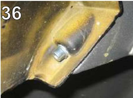
20. Bild36: Befestigen Sie die Tankblenden abschließend links und rechts am Tank mit jeweils
