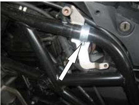
9. Montieren Sie den Tankhalter oben links wie auf den Bildern 10 und 11. Die Befestigung erfolgt identisch wie bei Tankhalter oben rechts!
