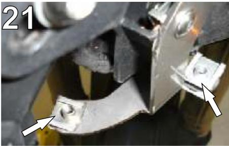
**Achtung! Die Positionen von Schnabel, Tankblenden und Haltern müssen nach der Montage des Tanks evtl. nochmal korrigiert werden. Die Schrauben dann bitte erst nach der endgültigen Festlegung der Positionen festschrauben!**
