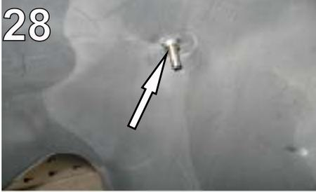
16. Befestigen Sie anschließend den Überlaufstutzen M6 mit Dichtring Alu D6 an der Unterseite des Tanks wie in Bild28 und stecken Sie ein ausreichend langes Schlauchstück Tankentlüftung 5x2 auf den Stutzen (ca. 70cm). Verlegen Sie den Schlauch später nach unten! Bild29 zeigt die Verlegung des Überlaufschlauchs (U) nach unten!
