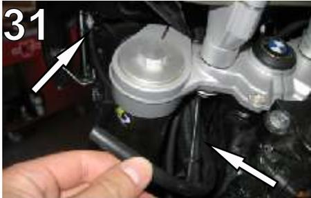
**Prüfen Sie unbedingt mit vollem Lenkeinschlag, nach links und nach rechts, dass alle Schläuche frei liegen, nicht gequetscht werden und zugentlastet sind.**
