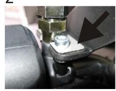
2. Eine Unterlage positionieren wie in Bild1 2. Place one washer as shown in pic. 1
