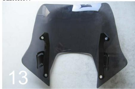
9.) Bereiten Sie nun das Windschild zum Einbau vor. Dafür setzen Sie bitte die Halterungen recht und links an das Windschild, wobei an den Bohrungen jeweils eine Kunststoff- U-Scheibe (I) dazwischen gelegt wird. Mit Hilfe der Senkschrauben M5x12 (J) und den schwarzen Kunststoffmuttern (K), auf der Vorderseite der Scheibe, werden die Halterungen an der Scheibe angebracht (Bild 13, 14).
