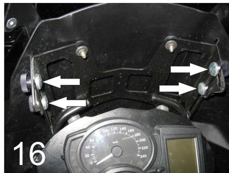
ACHTUNG: Es kann passieren, dass sich die Kunststoffmutter von selbst löst. Alternativ liegen im Lieferumfang deshalb 4 selbstsichernde Muttern M6, 4 U-Scheiben M6 und ein Werkzeug für den Schlüsselanhänger, mit dem diese Muttern festgezogen bzw. gelöst werden können. Bei seltener Verstellung des Windschildes empfehlen wir deshalb die selbstsichernden Muttern zusammen mit den U-Scheiben zu verwenden.
