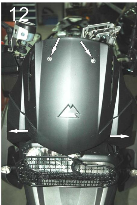
Bei den zwei mittleren Schrauben setzen Sie den Maulschlüssel bitte von oben an. (Bild 11) Drücken Sie die Instrumentenabdeckung ein wenig weg, um besser an die Muttern heranzukommen, verbiegen Sie diese aber nicht. Kleben Sie in diesem Fall auch den selbstklebenden Moosgummi auf die rechte und linke Strebe des Vorbaus (zwischen den Vorbau und die Instrumentenabdeckung), um einen Abrieb der Beschichtung zu minimieren.
