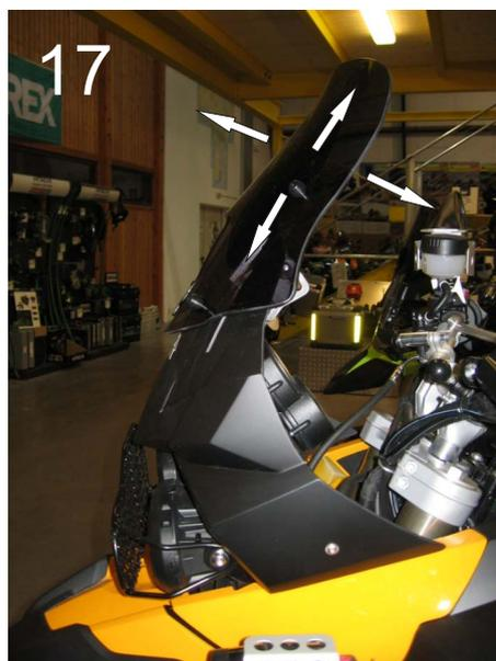
Sie haben die Möglichkeit, bei gelösten Schrauben, die Scheibe sowohl in der Höhe als auch nach vorne und hinten zu verstellen. (Bild 17)
