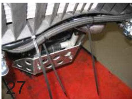
34.) Benzinschlauch und Kühlerschutz an vorderem Tankhalter mit Kabelbinder befestigen.
