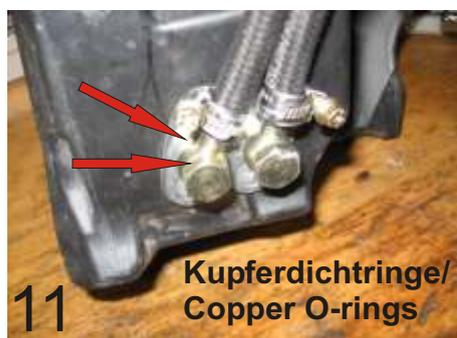
17.) Benzinleitungen an Ring Löt Stück M12 aufstecken und mit Schraubshellen befestigen. Mit Hohlschrauben und Kupferdichtringen die Leitungen befestigen. Tipp: Benzinleitung erst zum Schluss auf die entsprechende Länge kürzen!!
