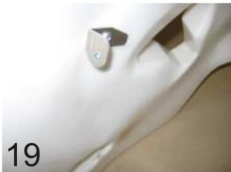
26.) Halter in Fahrtrichtung rechts mit LiKo Schraube M6x12mm befestigen.
