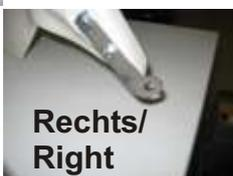
25.) Tankhalter links und rechts mit 4x Schraube 6- kant M6x12mm und U-Scheibe M6 groß befestigen, aber noch nicht fest ziehen!
