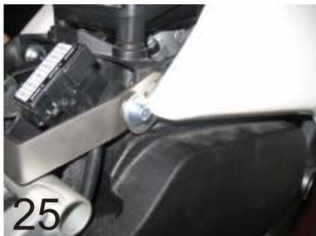
32.) Zusatztank einbauen; dazu muss der Tank vorne etwas gespreizt werden um ihn über die vorderen Tankhalter überstülpen zu können. Tank mit 2x Innensechskant M6x20mm und U-Scheibe M6 groß befestigen. Nun können die Schrauben 6-Kant, vom Tankhalter, angezogen werden.
