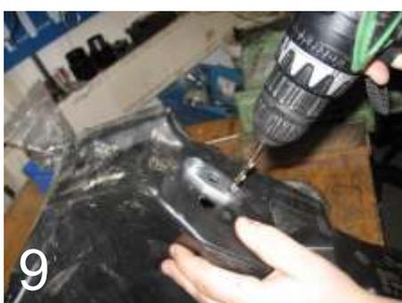
15.) Den inneren Benzinanschluss als Bohrschablone verwenden. Zuerst die 6mm Bohrlöcher setzen. Anschließend die Platte mit den passenden Schrauben fixieren. Nun kann das 12mm Loch gebohrt
