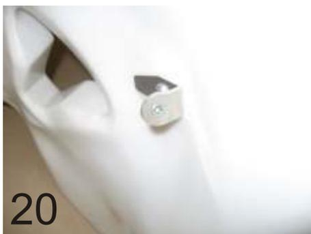
27.) Halter in Fahrtrichtung links mit LiKo Schraube M6x12mm befestigen.
