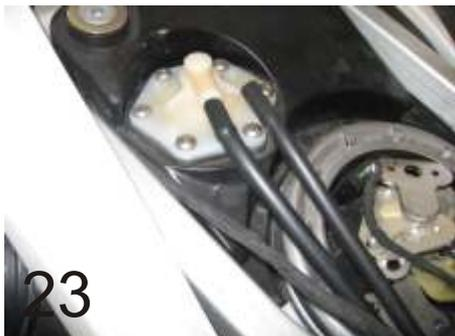
30.) Original Entlüftungsschlauch gegen mitgelieferten Benzinschlauch 6x35mm Ersetzen.
