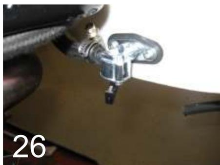
33.) Benzinschläuche so verlegen, dass diese nicht scheuern und nicht den Auspuff berühren! Tipp: Auf der linken Seite eine Schlaufe verlegen. Benzinschläuche auf die richtige Länge kürzen! Mit Schlauchschellen befestigen.
