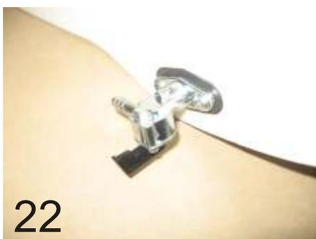
29.) Benzinhahn mit O-Ring, Viton Flachdichtung und Linseninnensechskantschrauben M6x12mm, wie auf Abbildung einbauen. Anschlussstutzen muss nach hinten zeigen!
