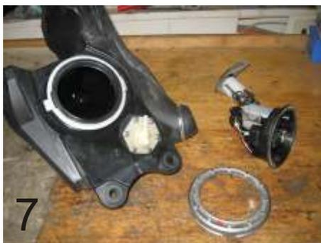
13.) Überwurfmutter von der Benzinpumpe mit geeignetem Werkzeug ausbauen.
