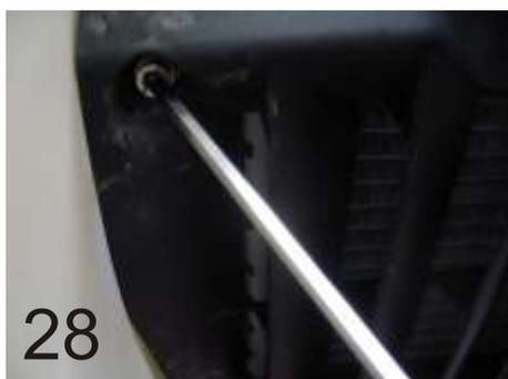
35.) Kühlerschutz oben mit Innensechskant M5x12mm und U-Scheiben klein befestigen.
