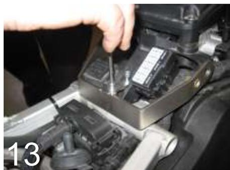
20.) Die Hintere Tankhalterung mit 2x Innensechskantschrauben M5x35mm und U-Scheibe M5 klein. Anschrauben, aber noch nicht fest ziehen!
