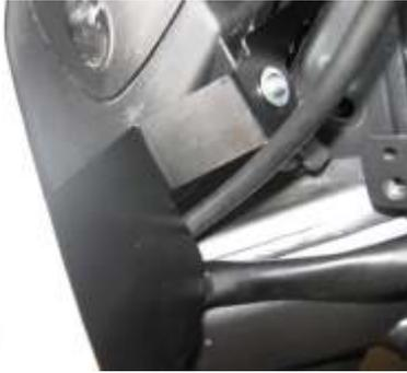
36.) Luffilterblende mit 2x LiKo Schraube M5x14mm und U-Scheibe groß befestigen.
