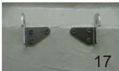
16.) Bereiten Sie nun die Maske für die Anbringung an den Vorbau vor. Setzen Sie dazu die Haken von innen an die oberen vorgesehenen Bohrungen (Bild 17). Von außen setzen Sie bitte die zwei V2A Blättchen auf (Bild 18).
