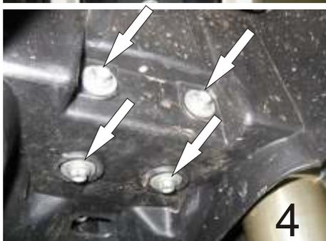
**HINWEIS:** Im Lieferumfang ist ein Aluminiumwinkel vorhanden, der zum Anbau eines Sportkotflügels benötigt wird. Mit Hilfe der original Schrauben des Kotflügels und diesem Winkel kann ein Sportkotflügel montiert werden. Bestellen Sie am besten gleich unseren passenden Sportkotflügel mit (Art.-Nr. 01-049-1401-0).
