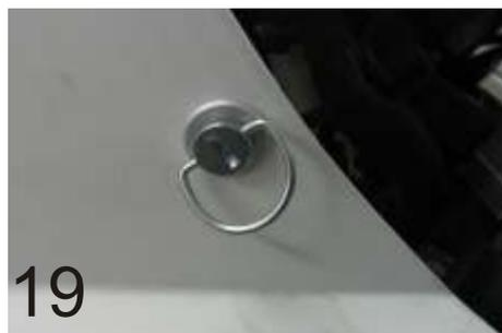
17.) In den seitlichen Bohrungen werden die Schnellverschlüsse angebracht. Legen Sie den Verschlüssen die im Lieferumfang enthaltenen Aluminium-U-Scheiben unter (Bild 19). Sichern Sie die Verschlüsse mit den gezahnten Sicherungsscheiben, indem Sie diese über auf den Verschlüssen einrasten lassen.
