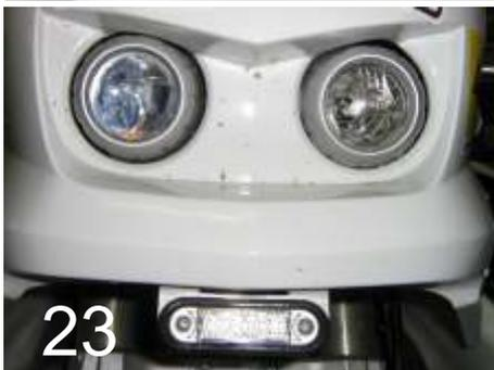
Schrauben Sie nach dem Bohren das Standlicht an den Halter; achten Sie dabei darauf, dass die Gummilippe des Standlichts zwischen Halter und Licht ist. Verwenden Sie die im Elektroniksatz beigefügten Schrauben und Muttern zum Befestigen des Lichts an der Halterung, sowie zur Befestigung der Halterung an der Maske.
