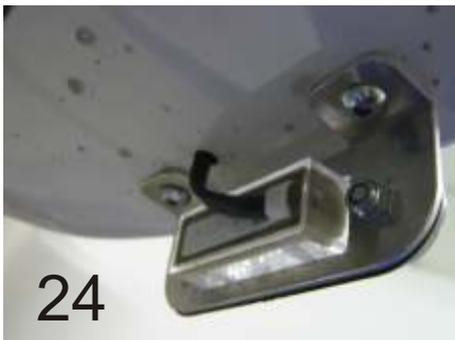
Zum Elektronischen Anschluss trennen Sie bitte die Leitung des original Standlichts im Bereich des original Lichts an. (Lassen Sie ein wenig Platz dazwischen, damit Sie das Licht später wieder verwenden können) Bringen Sie die Kabelverbinder-Buchsen und die Kabelverbinderstecker an die Leitungen des neuen Standlichts an und verbinden Sie diese miteinander. Verstauen sie die Kabel so, dass sie sich nicht verklemmen können oder gequetscht werden. Befestigen Sie Diese außerdem mit Kabelbindern.
