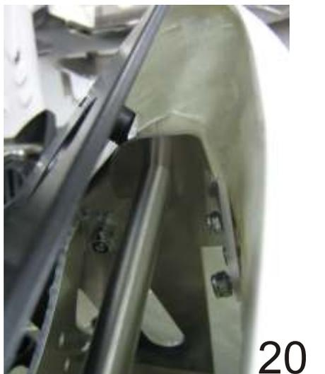
18.) Nun können Sie die Maske an den Vorbau anbringen. Hängen Sie die Maske dazu mit den Haken an den Vorbau (Bild 20). Ziehen Sie die Maske über die seitlichen Arme des Vorbaus und befestigen Sie diese mit den Schnellverschlüssen.
