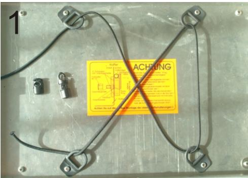
1. Einhängeösen an die innen liegenden Verschraubungen der Deckel-Verzurrhaken anbringen.
