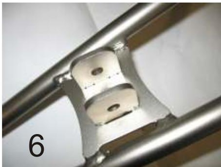
Die Soziusfußrastenaufnahme an dem Kofferträger positionieren und mit der im Lieferumfang enthaltenen Mutter M8 selbstsichernd, sowie einer U-Scheibe M8 befestigen (Bild6).
