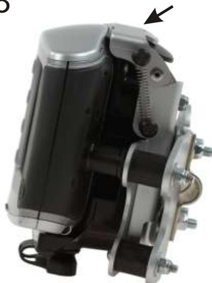
3. Verriegelung an der Lenkerhalterung schließen! (Bild 8)
