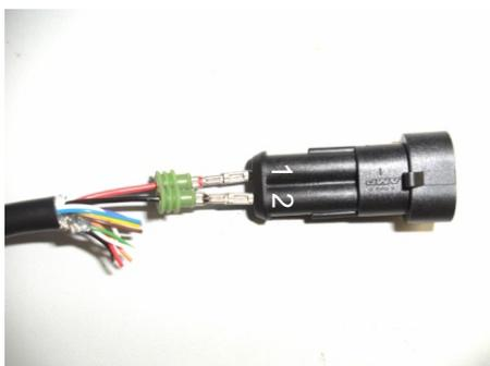
Stecken sie bitte den Schrumpfschlauch auf das Kabel auf, bevor sie in der Montage fortfahren.
