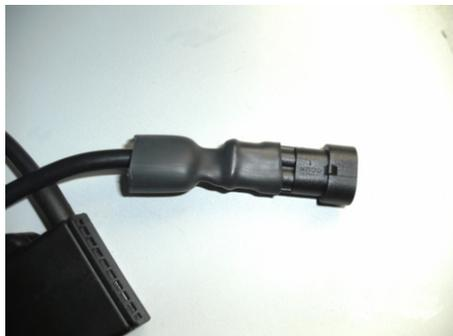
Schieben sie den Schrumpfschlauch über die Adern und das Steckergehäuse und schrumpfen sie diesen mit einem Heißluftfön, von der Gehäuseseite aus, zu.
