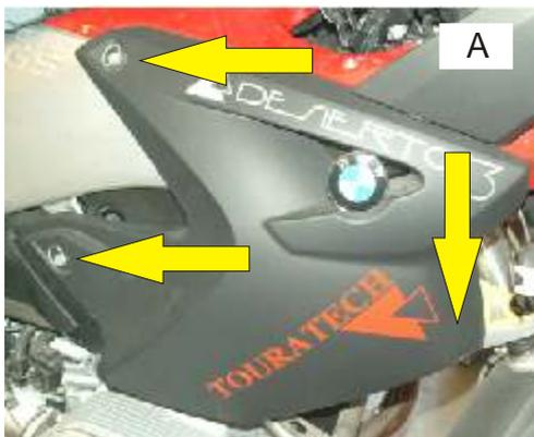
Demontieren Sie die Seitenverkleidung indem Sie die Schnellverschlüsse an den mit Pfeilen markierten Stellen lösen.
