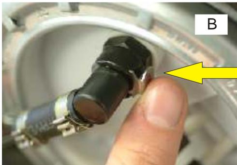
Entkoppeln Sie den Benzinschlauch am Tank. Achten Sie darauf, den Entriegelungshebel zu betätigen, um den Schnellverschluss nicht zu beschädigen.
