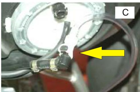
Verbinden Sie die Adapterleitung mit dem von der Benzinpumpe kommenden Benzinschlauch.
