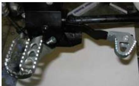
2.) Achten Sie darauf, das die Feder beim Einlegen an Ihrem neuen Bremshebel um diesen herumgreift. Schmieren Sie das Gleitlager und die Buchse E (welche Sie von Ihrem "alten" Bremshebel übernehmen) bitte ausreichend, um den Verschleiß zu minimieren.
