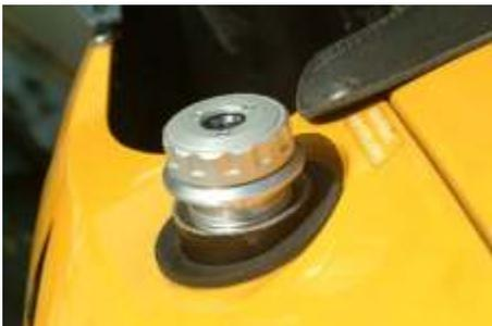
Den Ölstand können Sie mit Hilfe der oberen und unteren Markierungen am Peilstab ablesen. Dazu setzen Sie den Ölstopfen nur auf und schrauben ihn nicht ein. Ansonsten wird ein falscher Ölstand angezeigt.
