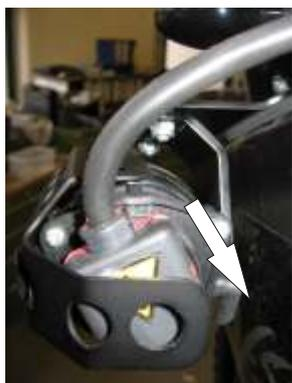
2.) Montieren Sie nun die Halterung des Scheinwerfers an Ihrem Motorrad. Verwenden Sie dazu die im Lieferumfang enthaltenen Schrauben M5x20 zusammen mit den U-Scheiben M5 groß. Schrauben Sie die Halterung, wie in Bild 11 gezeigt an.
