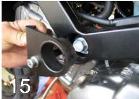
Die Laschen werden am Rahmen, links und rechts aufgesteckt, links die mit dem größeren Durchmesser und mit dem Verbindungsrohr fixiert. Dabei auf die richtige Position der Laschen achten, Bild 15-17. Ziehen Sie die Schrauben fest.
