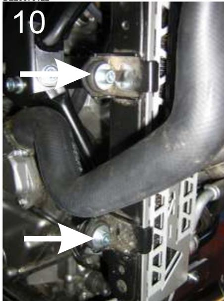
10.) Verwenden Sie zur Montage, an den im Bild 10 bezeichneten Stellen, die Schrauben M6x25, mit je einer selbstsichernder Mutter und beidseitig einer U-Scheibe M6 groß.
