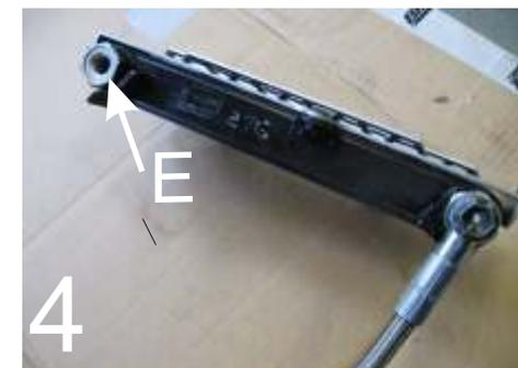
4.) Um die Ölleitungen am Kühler lösen zu können, benötigen Sie einen 24er Schraubenschlüssel, um damit am Anschluss (E) gegenzuhalten; tun Sie dies nicht bekommt der Kühler Beschädigungen, die dazu führen können, dass er nicht mehr dicht ist. (Bild 4)
