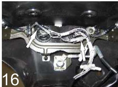
4.) Verbinden Sie die Kabelverbinder miteinander, so dass der Kontakt zwischen den Blinkern und der Elektronik des Motorrads entsteht. Überziehen Sie außerdem zur Sicherheit die Kabel mit den Schrumpfschlauchstücken, so dass ein Kurzschluss zwischen den Blinkern ausgeschlossen wird. Überprüfen Sie vor der entgeltigen Montage des Hecks, die Funktion der Blinker. Schließen Sie dazu die Batterie wieder An.
