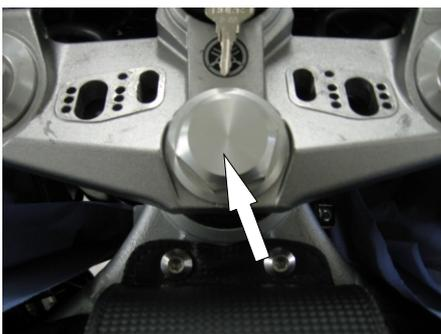
4. Lösen Sie anschließend die zentrale Lenkkopfmutter. Auch hier ist es sinnvoll, nach links, bis an den Lenkansschlag einzuschlagen. Anschließend entfernen Sie noch die unter der Mutter angebrachte Unterlagscheibe.
