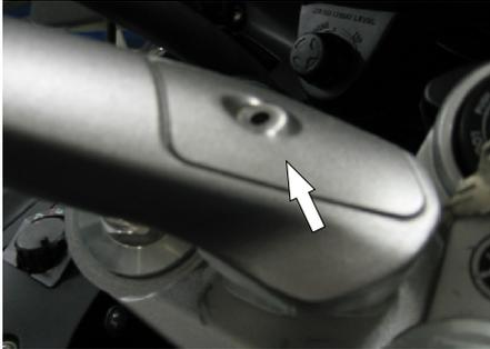
1. Entfernen Sie von beiden Lenkerhälften die Abdeckungen, unter welchen sich die Lenker-Befestigungsschrauben befinden.
