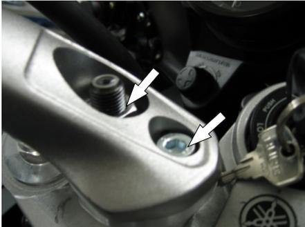
3. Mit einem großen Seitenschneider sollten Sie nun auf beiden Seiten die Drahtbügel von der originalen Grundplatte, welche unter der oberen Gabelbrücke sitzt, durchtrennen.
