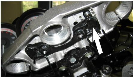
7. Die zwei beigelegten Schlauchstücke schieben Sie jetzt über die Bügel der Grundplatte (Bild 7). Der Schlauch sollte am Ende der Bügel ein klein wenig überstehen. Um diese Montage zu erleichtern, können Sie Silikonspray o.ä. anbringen. Zu leicht sollten sich die Schläuche jedoch nicht anbringen lassen.
