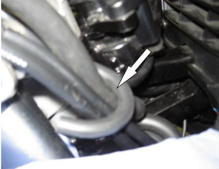
13. Bringen Sie jetzt die Brems- und Kupplungsleitungen sowie die Kabelstränge (Bild 13) hinter die Laschen der Grundplatte.
