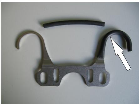
Es ist durchaus normal dass jetzt die Standrohre ein wenig verspannt sind und Sie diese dadurch mit ein wenig Kraftaufwand und Geschick in die Bohrungen der Brücke bringen müssen.
