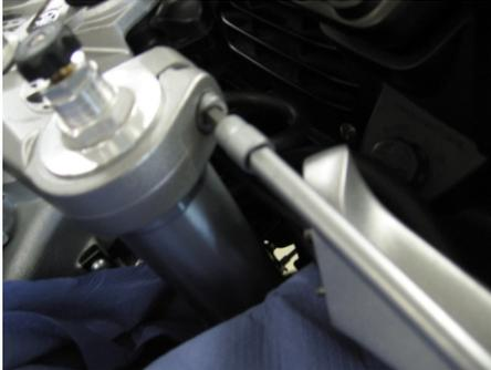
5. Lösen Sie jetzt links und rechts die Innensechskantschrauben der oberen Gabelbrücke.
