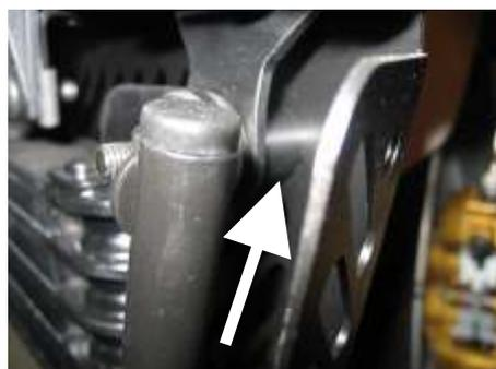
4.) Den Kühlerschutz anschließend wie in Bild 2/3 an den Aufnahmepunkten der Blende befestigen mit:
