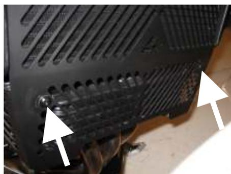
2.) Die Blende zwischen Kühler und Ölkühler entfernen!
