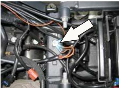
2. Die Stecker von Tacho und Scheinwerfer abziehen (liegen zwischen den Scheinwerfern!) und den Kabelbaum nach unten aus dem Vorbau herausziehen.
