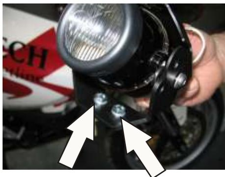
15. Die vorderen Schrauben an der Blende des Scheinwerfermoduls entfernen, Scheinwerfer und Blende nach oben klappen und die beigelegen
