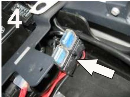
6. Die Sicherung mittels Kabelbinder im Hohlraum hinter dem Batteriekasten befestigen. (Bild4, Abbildung zeigt die Befestigung zusammen mit der Sicherung unseres Nebel-Zusatzscheinwerfers)
