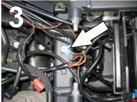
**Achtung! Bei Überbelegung des Minuspols an der Batterie das Massekabel am Rahmen befestigen (Bild3)**
