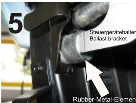
7. Steuergerätehalter wie in Bild5/6 am Kühler befestigen mit
